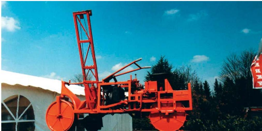
Abb. 6: Restauriertes dreirädriges Böschungsmähgerät der Firma Berkenheger
